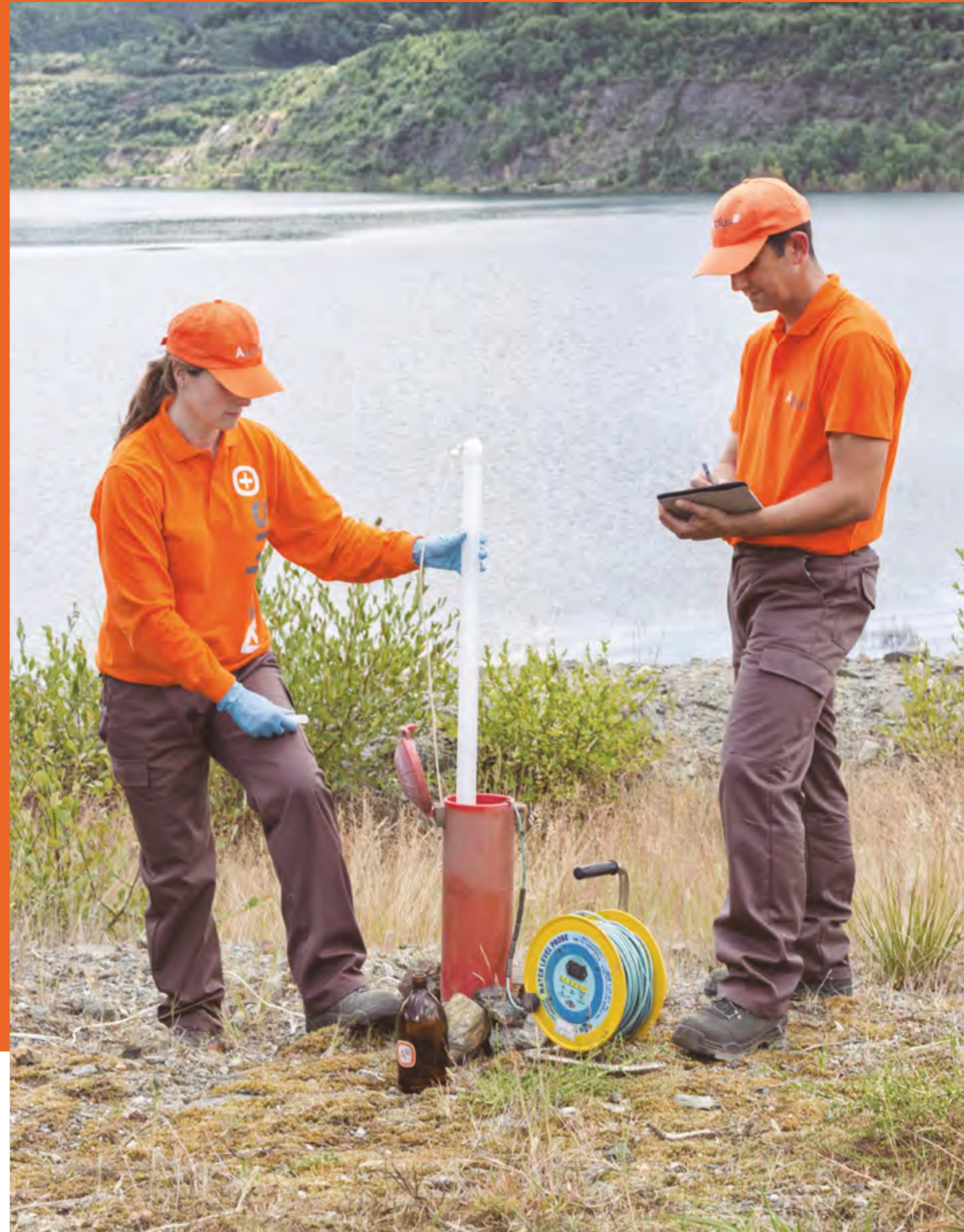
Environmental inspección, water sampling in a mine.
