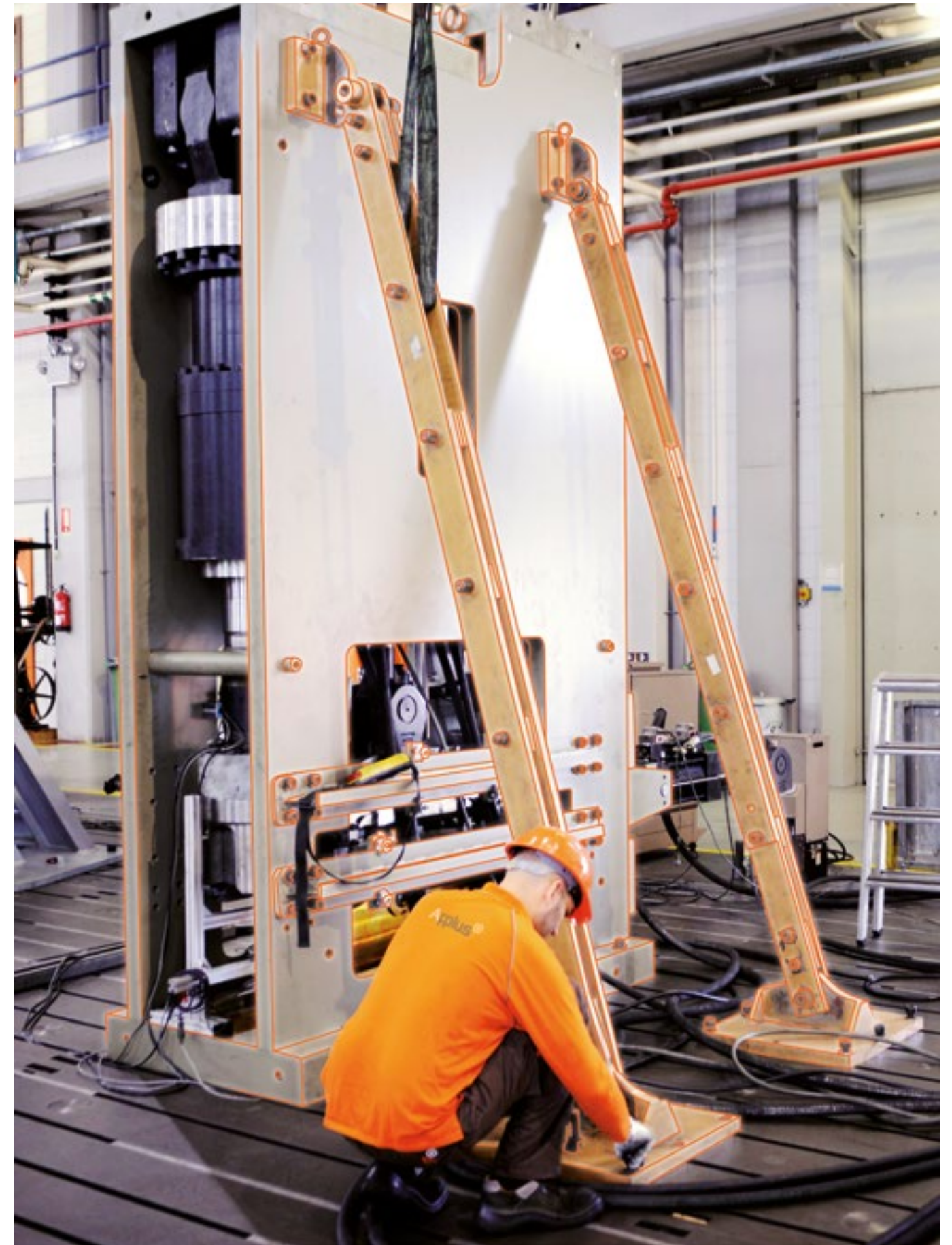
Ensayo de fatiga de un soporte de motor aeronáutico.
