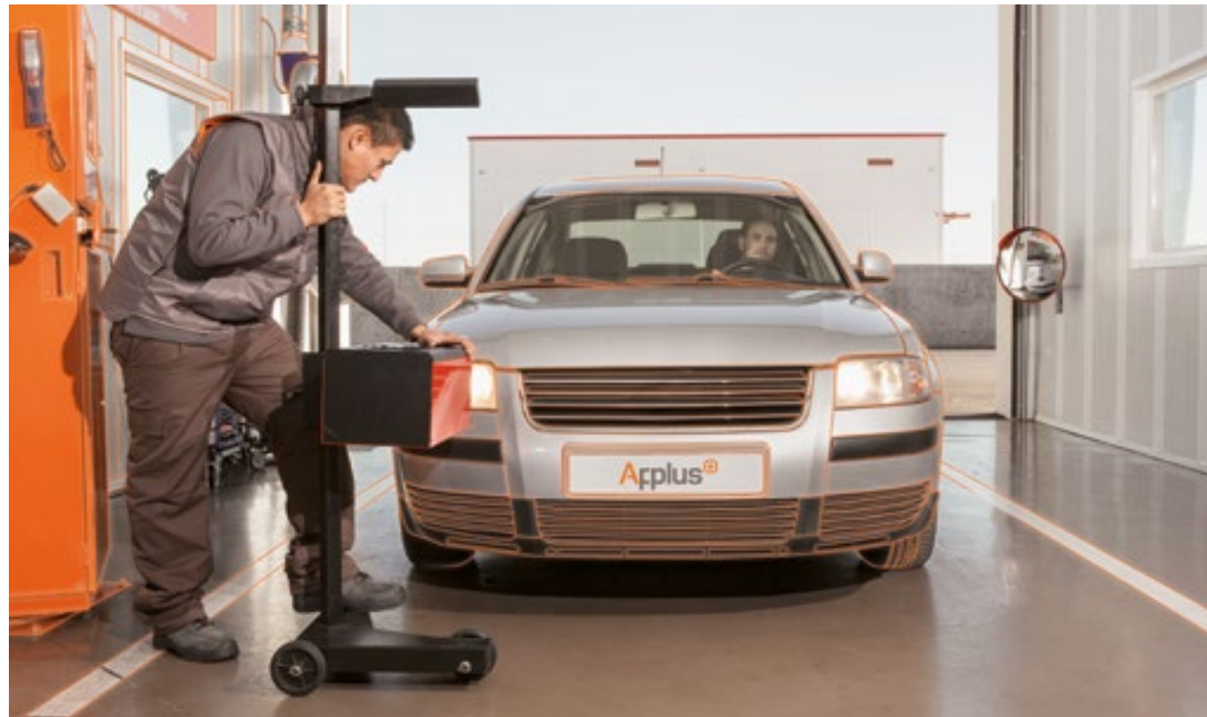
Prueba de alineación de faros.
