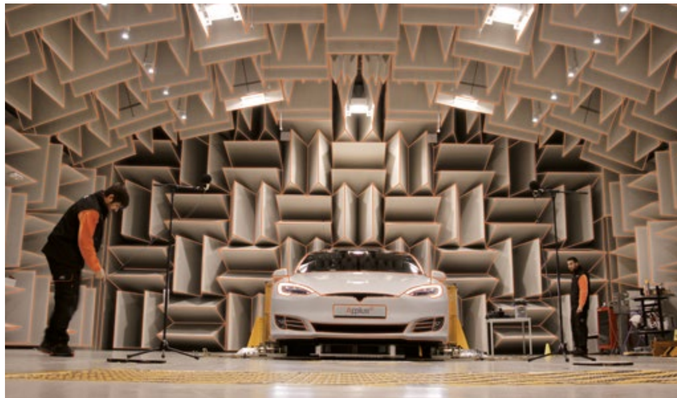
Ensayo acústico de la percepción de un peatón frente a un vehículo eléctrico.
