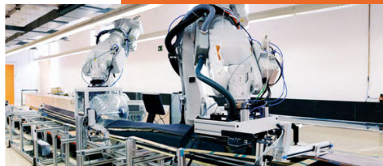
A+ Glide Forming: tecnología innovadora desarrollada por Applus+ para la fabricación de refuerzos estructurales de fibra de carbono para aviones
